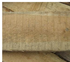
Рисунок 2 – Риски на поверхности древесины
