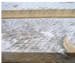
Рисунок 1 – Мшистость поверхности древесины
