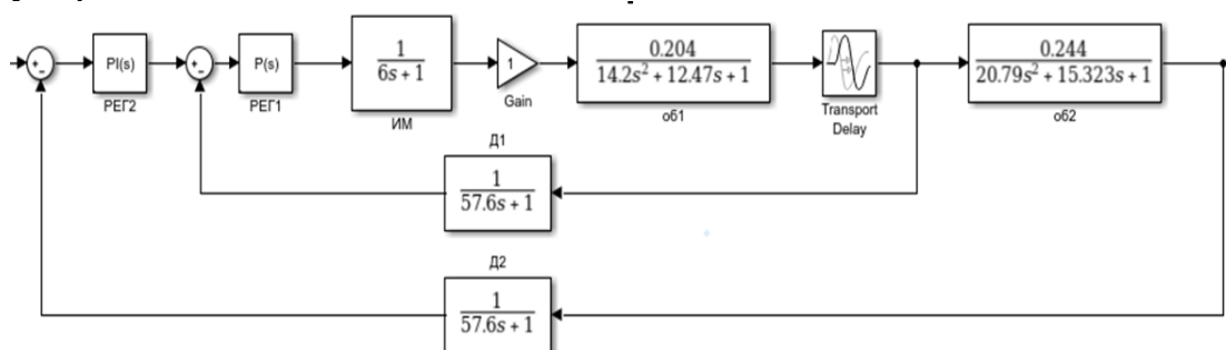
Рисунок 2 – Структурная схема системы каскадного регулирования
