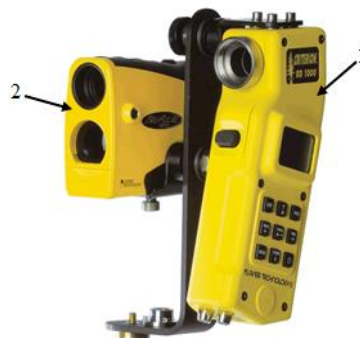
Рисунок 2 – Дендрометр Criterion RD 1000 и дальномер TruPulse 360 на одном штативе
