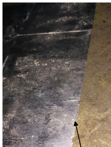
Разрушение режущей кромки
