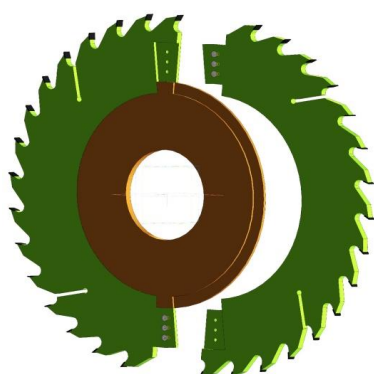
Рисунок 1 – Принципиальный вид проектируемой пилы дисковой сборной
