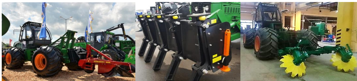
а – плуг лесной ПКЛ-70; б – грабли лесные; в – фреза почвообрабатывающая активная Рисунок 4 – Быстросъемные рабочие органы для проведения лесохозяйственных работ
