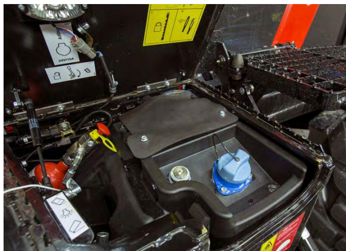
Рисунок 3 – Новый бак AdBlue с защитой от проливания и улучшенной крышкой, расположенный в передней части форвардера
