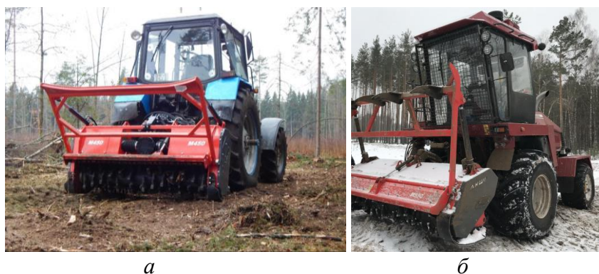
Рисунок 2 – Агрегатирование мульчеров АНWI M450m-1900 ( а ) и M550m-2410 ( б ) на базовое шасси BELARUS-1221В.2 и универсального энергетического средства УЭС-2-280А «ПАЛЕССЕ 2U280А» соответственно
