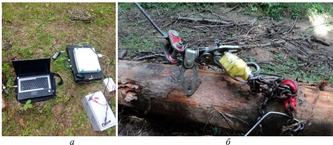
a – измерительное оборудование (ноутбук, Spider8, аккумулятор); б – датчик силы НВМ U9B
