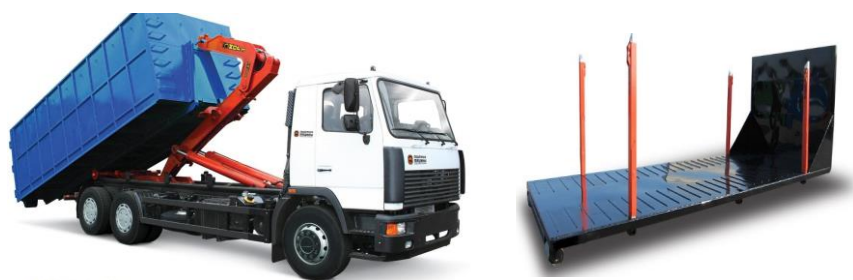
а б а – кузов-бункер; б – грузовая платформа
