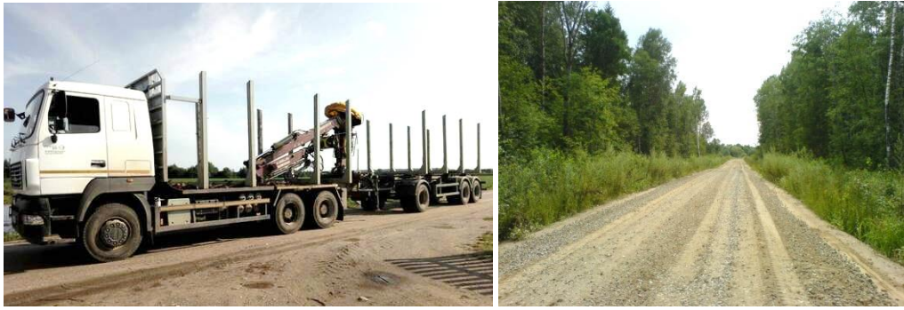
Рисунок 2 – Сформированный лесовозный автопоезд для вывозки сортиментов (а) и элемент дорожной сети – лесная дорога (б)
