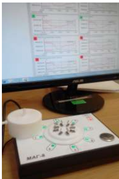
Рисунок 1 – Многоканальный анализатор газов «МАГ-8» с программным обеспечением
