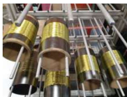
Рисунок 2 – Формование полимерного волокна: а - фильерный комплект; б - приемное устройство; в - шпули с волокном.
