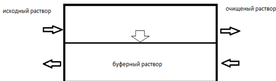
Рисунок 1 Схема диализной установки
