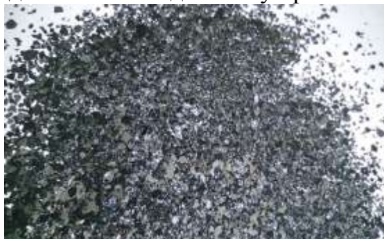
Рисунок 5. – Полученный диоксид марганца \gamma - модификации
