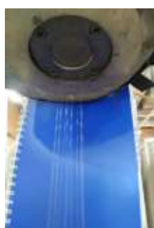
Рисунок 2 – Формование полимерного волокна: а - фильерный комплект; б - приемное устройство; в - шпули с волокном.
