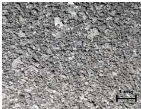
Рисунок 4. – Порошок цинка, полученный из щелочного электролита
