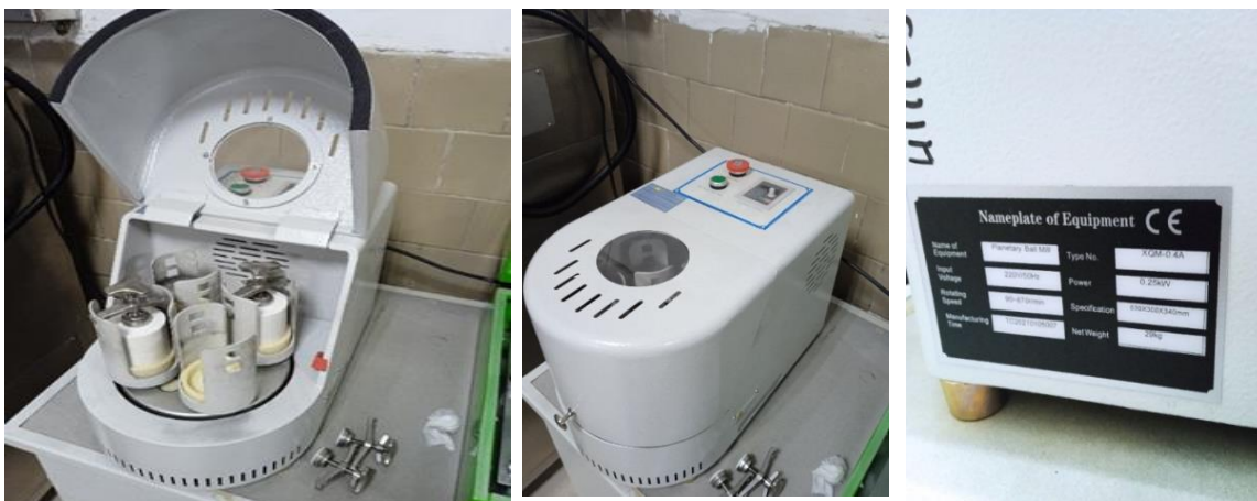
Рисунок 2 – Лабораторная мельница «Planetary Ball - XQM-4,4 А»
