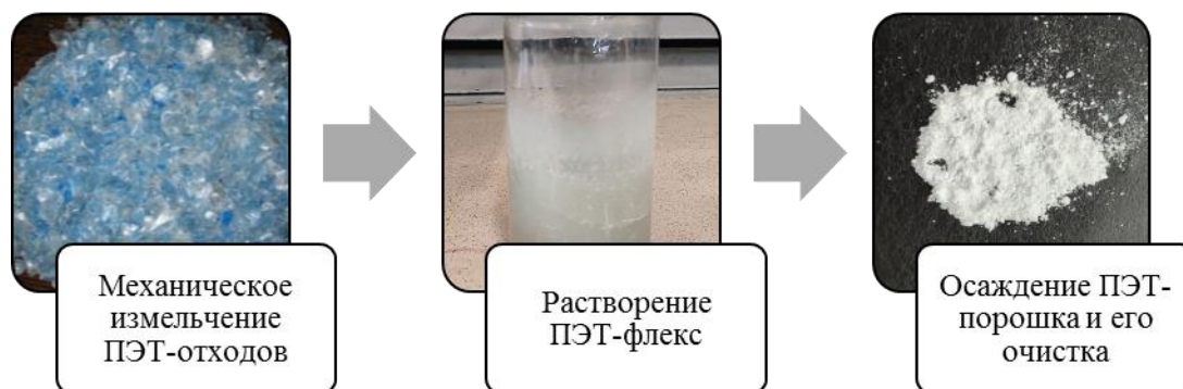
Рисунок – Схема получения полимерных порошков из ПЭТ-отходов
