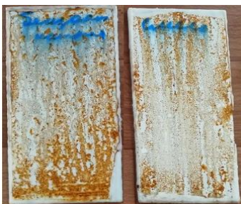
Рисунок 1 – Пластины, покрытые грунтовками с бензоатом натрия и смесью бензоата натрия и нитрита натрия (слева направо) в солевой камере спустя 120 часов
