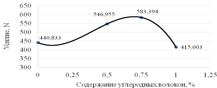
Рисунок 3 – Зависимость разрушающего усилия от содержания углеродных волокон
