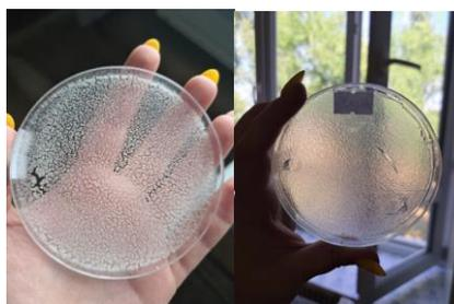
**Рисунок 1 – Пленки, полученные первым методом, высушенные: в сушильном шкафу (слева); на воздухе (справа)**
