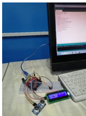
Рисунок 4 – Моделирование датчика. Процесс измерения
