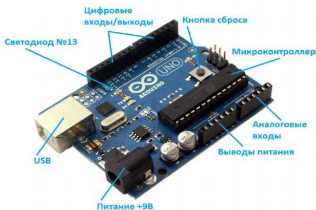
Рисунок 2 – Макетная плата Arduino Uno
