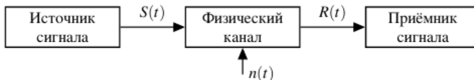
Рисунок 1 – Структурная схема физического канала в общем виде
