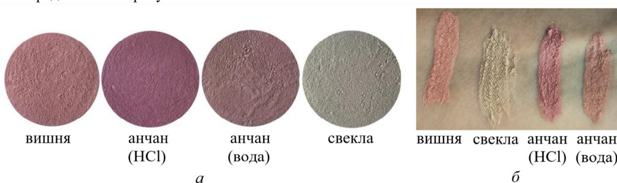
Рисунок – Полученные образцы красок в сухом виде (а) и результат их применения (б)
