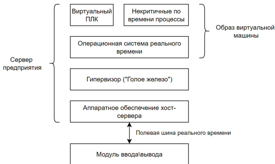
Рисунок 1 – Архитектура виртуального ПЛК на сервере с одним виртуальным ПЛК
