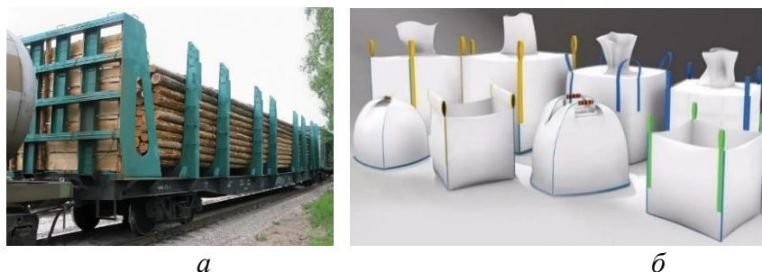
а – жесткий железнодорожный контейнер; б – варианты гибких контейнеров Рисунок 4 – Контейнеры по жесткости конструкции
