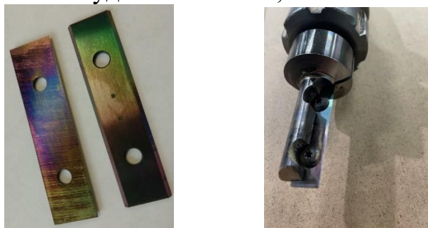
Рисунок 2 – Ножи с износостойким алмазоподобным DLC-покрытием для вибрационного резания древесных материалов
