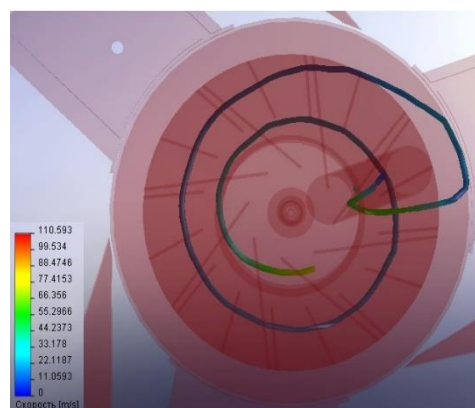
Рисунок 3 – Траектория движение одиночной частицы материала в межлопастном пространстве ротора и в кольцевом зазоре между лопатками и корпусом смесителя при n = 1500 об/мин
