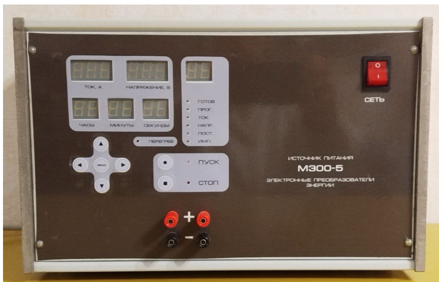
Рис. 1 – Программно-аппаратный комплекс для проведения высоковольтных анодных процессов в нестационарных режимах
